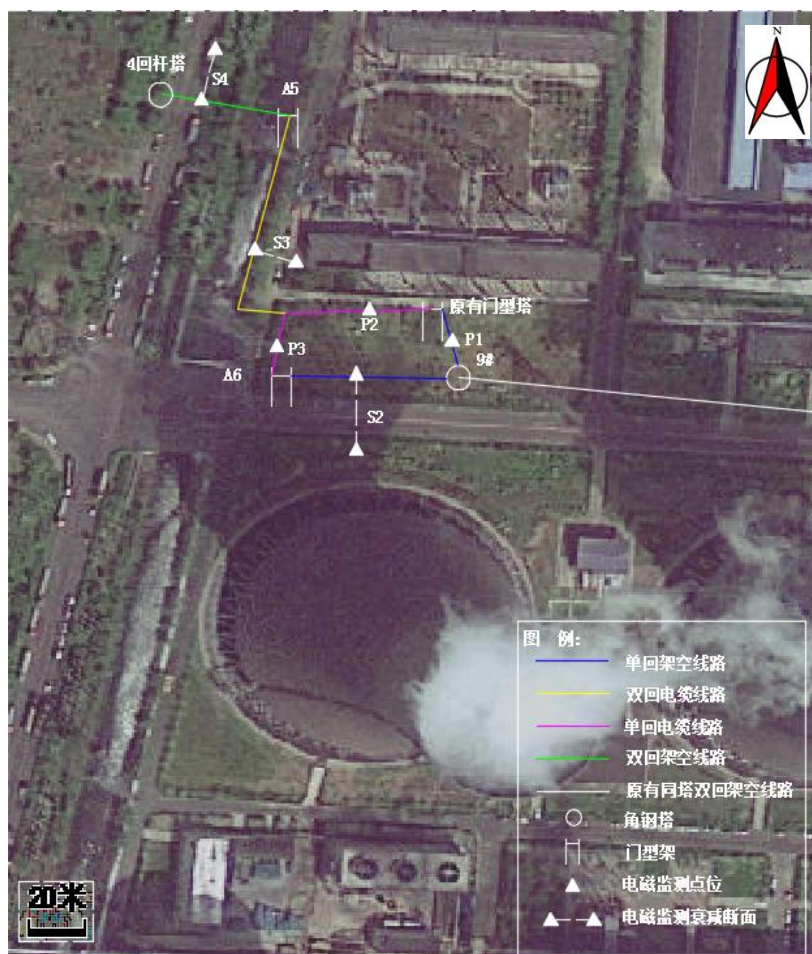
图 7-2 本工程输电线路检测点位示意
